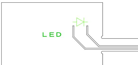
SWとLEDで別シートに引き回せるため、スペースが広く引き回しがラクにできる。
